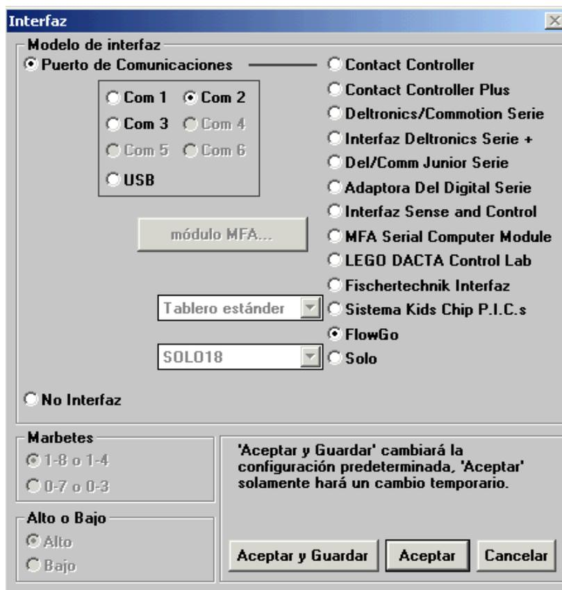
Como se observa, permite utilizar alrededor de una docena de placas controladoras accesibles mediante puerto serie (Com) y/o USB, entre ellas las de Fischertechnik, LEGO DACTA y FlowGo. El puerto serie que ocupa la interfaz puede seleccionarse mediante los botones de radio **Puerto de comunicaciones** y **Com X**.
